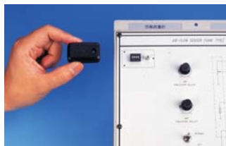
В каждом модуле имеется 4/8-разрядный двухпозиционный переключатель для моделирования отказов
