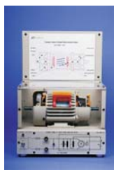
ЕМ-3350-1С Однофазный индукционный двигатель
