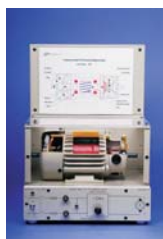
ЕМ-3350-1А Двигатель постоянного тока с постоянными магнитами
